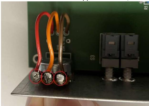
Achten Sie darauf, dass sich kein Kabel kreuzt. Sie müssen alle parallel zueinander nach oben verlaufen und auch so an das Poti gelötet werden.
